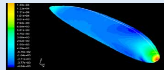
Числено изследване на обтичането на корпуса на погводен апарат
