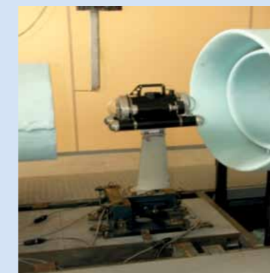
Моделни аеро- и хидродинамични изпитания за проектиране на системата за задвижване и управление на погводен мини-апарат
