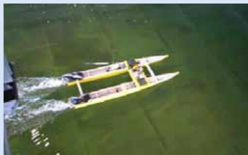
Изследване на маневрените качества и курсовата устойчивост на катамаран на тиха вода и вълнение при променлива дълбочина на водата
