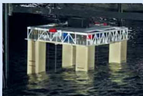
Моделни изпитания за определяне на поведението на сондажни платформи при вълнение
