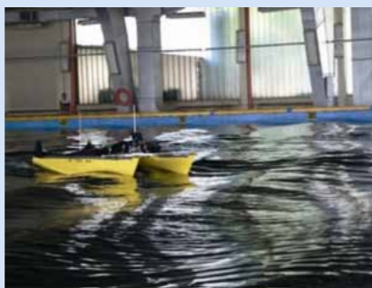
Изследване на маневрените качества и курсовата устойчивост на катамаран на тиха вода и вълнение при променлива дълбочина на водата
