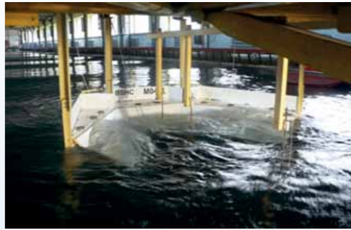
Моделни изследвания на ефективността на устройства за усвояване на енергията от възобновяеми морски и речни енергийни източници
